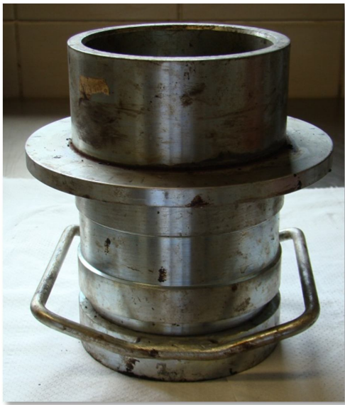
Figura 2.22 – Moldes utilizados na produção de provetes para o método Marshall. (LREC)
