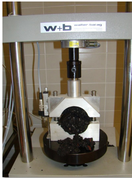
Figura 2.25 – Equipamento utilizado no ensaio Marshall. (LREC)
