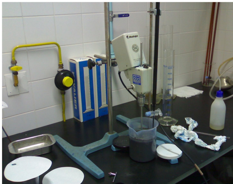
Figura 2.11 – Equipamentos utilizados na realização do ensaio de azul-de-metileno.
