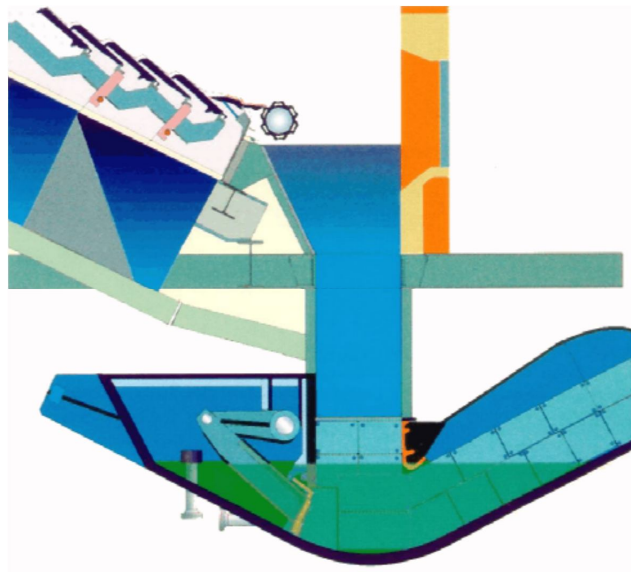
Figura 1.13 – Extractor de escórias. [2]
