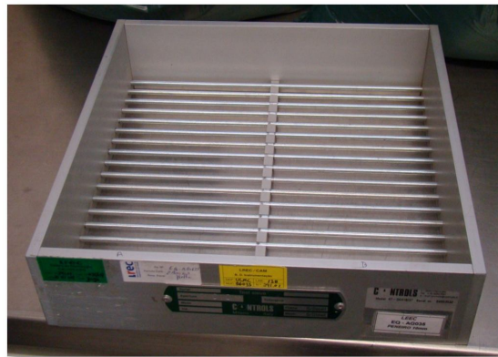
Figura 2.9 – Peneiro de barras utilizado na determinação do índice de achatamento. (LREC)
