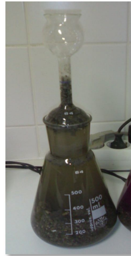
Figura 2.15 – Determinação da massa volúmica das escórias pelo método do picnómetro.
