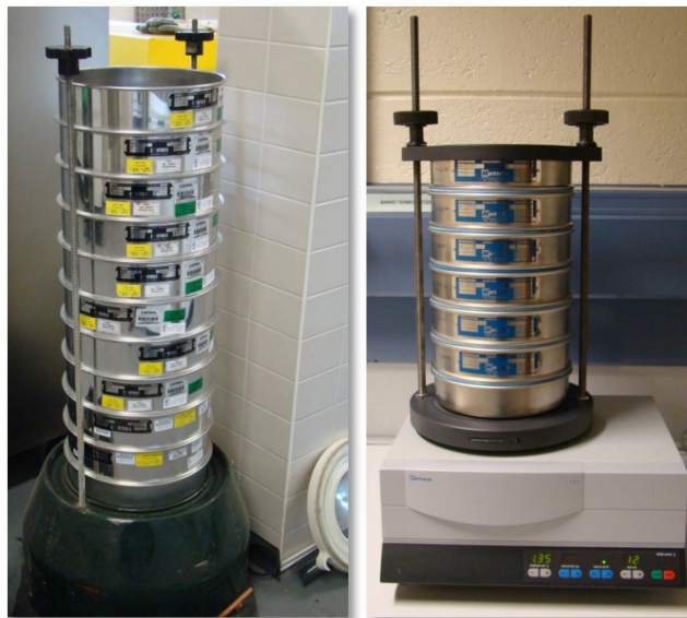
Figura 2.7 – Série de peneiros utilizada na análise granulométrica. A) Esquerda – LREC; B) Direita – Laboratório da Valor Ambiente.
