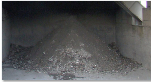
Figura 2.2 – Pilha de agregado cônica – Edifício de escórias da ETRS.
