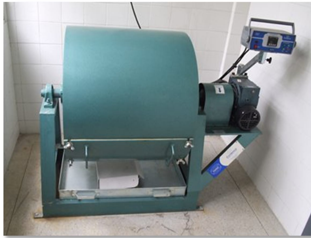
Figura 1.19 – Máquina de Los Angeles para a realização do ensaio de desgaste de agregados.
