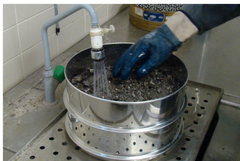
Figura 2.6 – Lavagem das escórias num peneiro com abertura de malha de 63 \text{ }\mu\text{m} .
