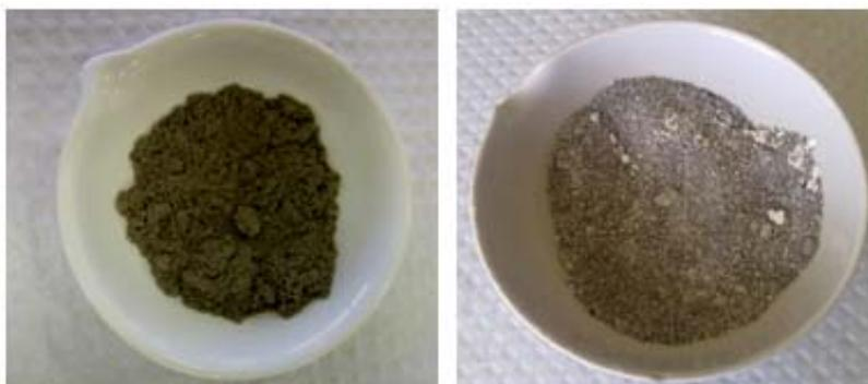
**Figura 31** - Amostras de cinzas recolhidas no sistema de combustão em leito fluidizado:  $CV_L$  e  $CF_L$  (da esquerda para a direita).
