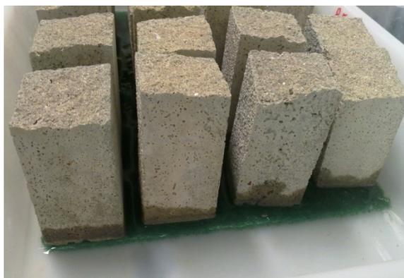
Figura 29 – Alguns provetes durante o ensaio de absorção de água por capilaridade.
