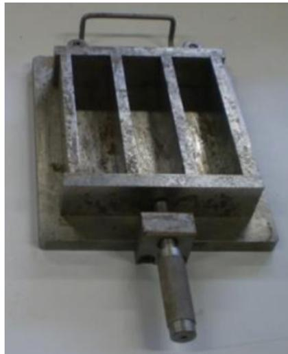
Figura 22 – Exemplo de molde utilizado no fabrico de provetes.
