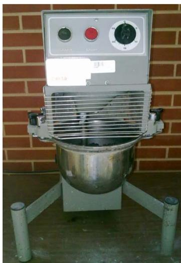
Figura 21 – Misturador de laboratório usado nas várias amassaduras.
