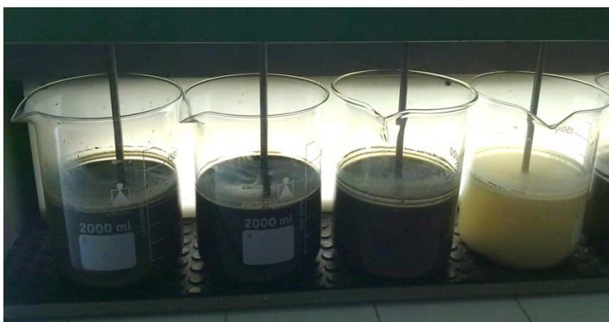
**Figura 17** – Agitação das amostras com agitador mecânico. As amostras correspondem às cinzas  $CV_G$ ,  $CF_G$ ,  $CV_L$  e  $CF_G$  (da esquerda para a direita).
