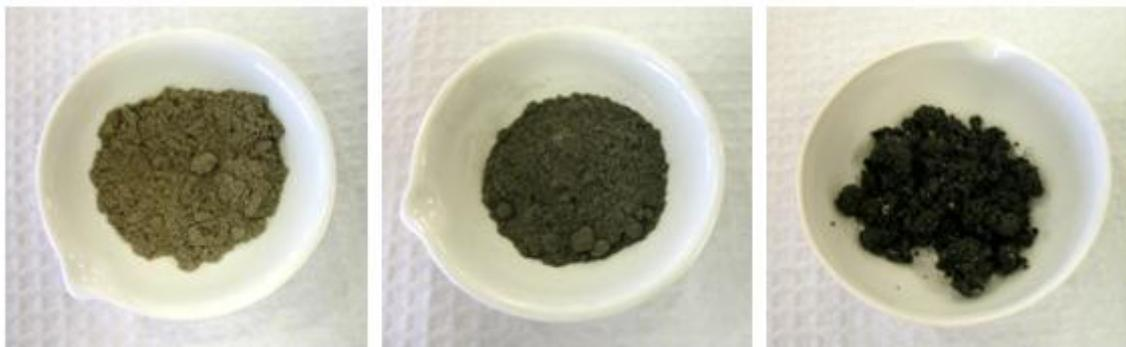
**Figura 30** – Amostras de cinzas recolhidas no sistema de combustão em grelha:  $CV_G$ ,  $CVA_G$  e  $CF_G$  (da esquerda para a direita).
