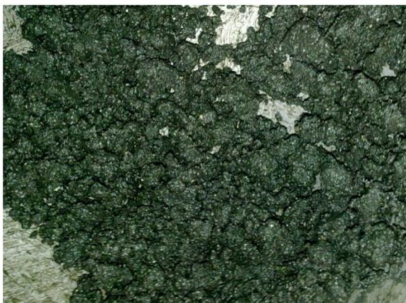
Figura 20 – Aspecto visual da substituição de 30% de areia por cinzas de fundo da grelha.
