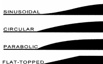
Figura 58 – Exemplos de perfis de lombas (Ewing, 1999)
