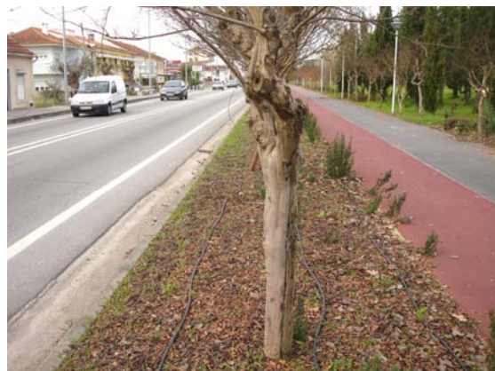
Figura 113 – Segregação da estrutura pedonal e da ciclável da viária, Mealhada
