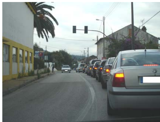
Figura 75 – Semáforos controladores de velocidade em Ceira (Coimbra) – EN 17
