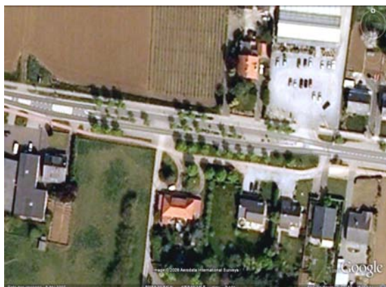
Figura 87 – Estrangulamento com ilhéu separador em Rillaar – 1.ª zona (Google Earth)
