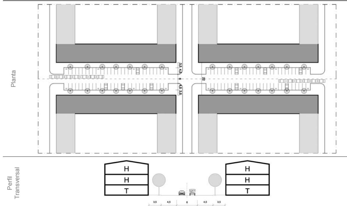
Quadro 6.4 - Dimensionamento da rua-tipo da forma clássica com atravessamento fraco.
