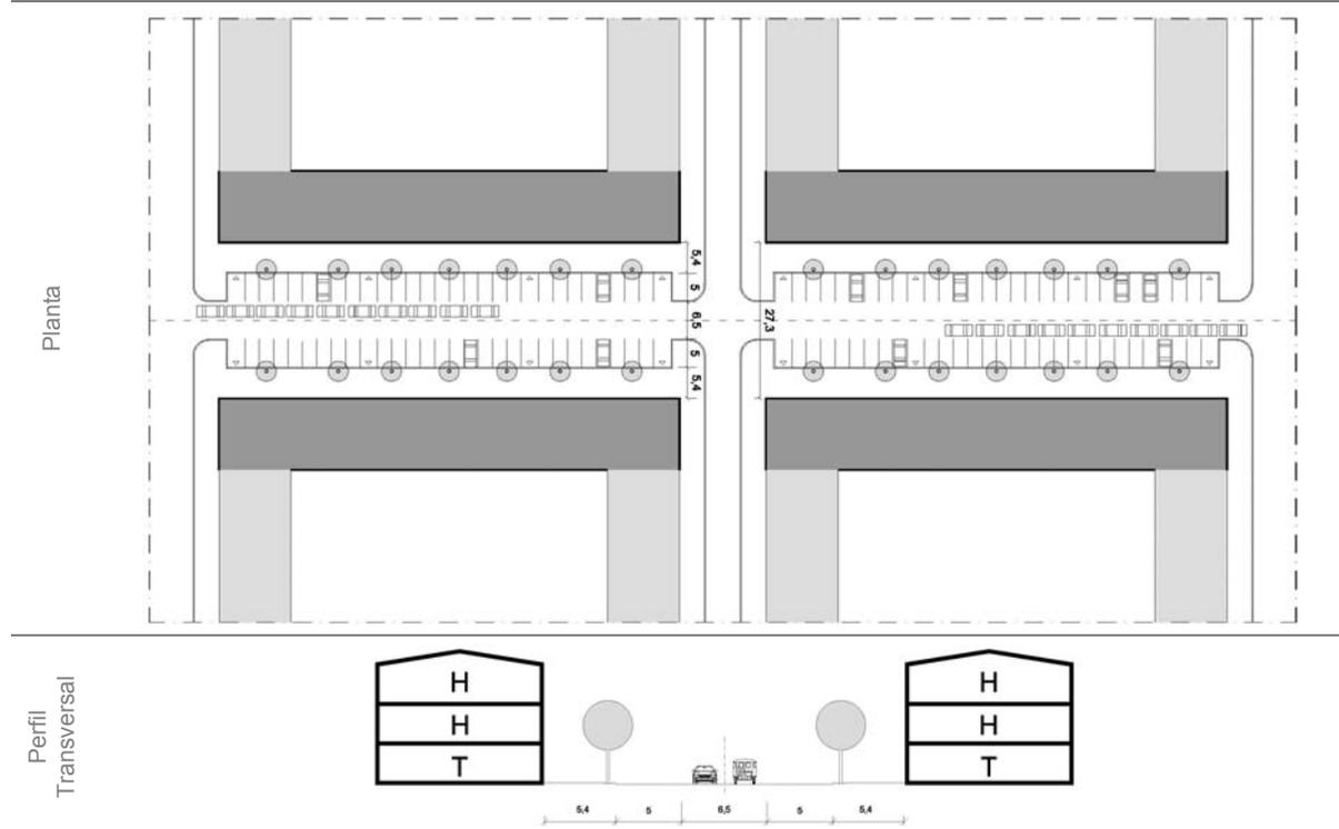
Quadro 6.3 - Dimensionamento da rua-tipo da forma clássica com atravessamento intenso.
