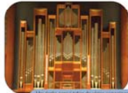
Um órgão possui tubos de vários comprimentos que produzem as diferentes notas. Em cada um dos tubos, a frequência do som fundamental é inversamente proporcional ao comprimento (distância de um antinódo).
