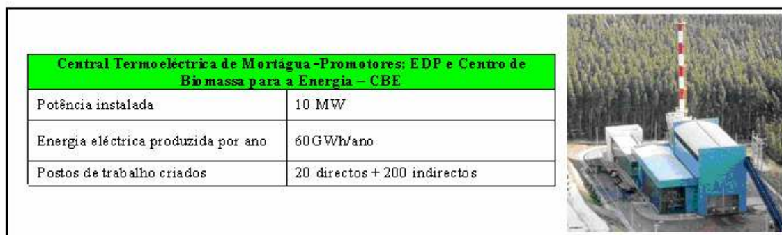
Figura 14 - Caracterização da central termoelétrica de Mortágua (informação retirada de [113, 144, 83]; fotografia retirada de http://www.energiasrenovaveis.com , acedido a 28/08/2006).
