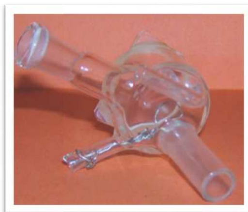
Figura 9.2 – Fotografia da célula utilizada, no interior da qual se coloca a solução com a amostra a analisar, o eléctrodo de prata, o de referência e o de platina (fio metálico que se observa na parte esquerda da fotografia).
