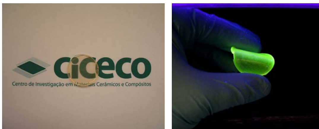
Figura 5-23 Fotografias do nanocompósito híbrido U/(CdSe/ZnS/APS) sob luz visível e sob luz UV.
