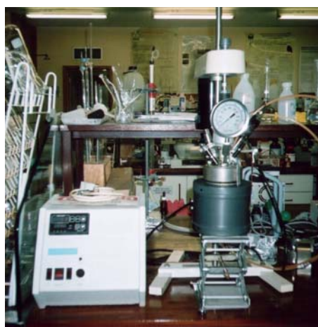
Figura 2.3 – Reactor e controlador de temperatura e de agitação usado no branqueamento da pasta kraft de papel.
