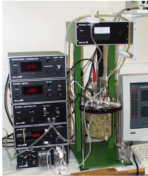
Figura 2.2- Bioreactor usado na produção da lacase por Trametes versicolor .
