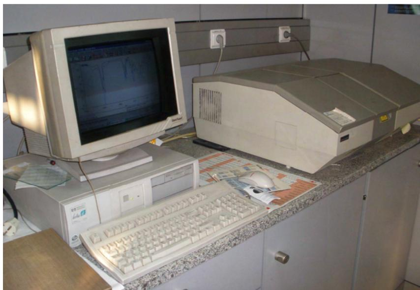
FIGURA 26 – ESPECTROFOTOMETRO I.V. – FTIR
