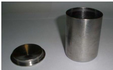
**FIGURA 24** – PICNÓMETRO DE METAL
