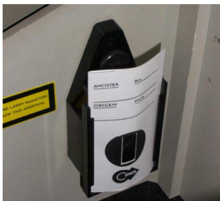
FIGURA 29 – JANELA DO ESPECTROFOTOMETRO I.V. – FTIR COM A AMOSTRA
