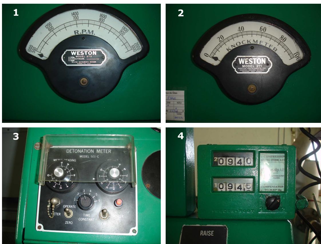
Figura 12 – Pormenores do Motor CFR: 1- Medidor da Velocidade de Rotação, 2- Medidor da Detonação, 3- Medidor da Ignição da Detonação, 4-Contador Analógico.
