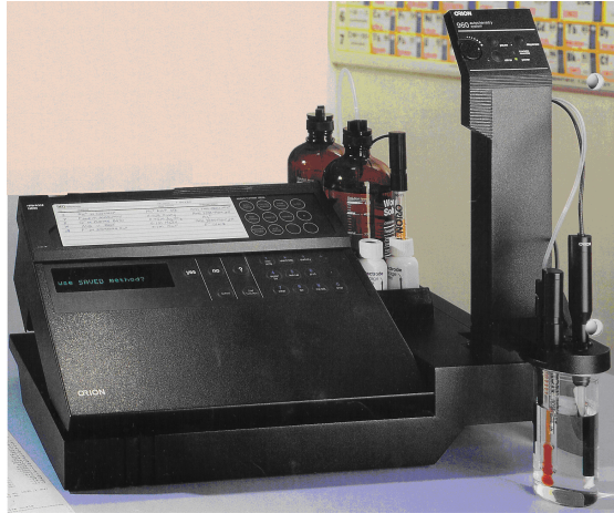
Figura E.6 – Imagem ilustrativa de um titulador automático Orion com dispenser e de um eléctrodo de pH.
