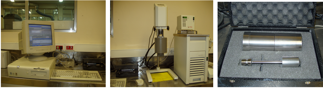
Figura E.3 – Imagem ilustrativa de um viscosímetro de cilindros coaxiais, ligado a um banho termostático e dos cilindros coaxiais utilizados na medição da viscosidade.
