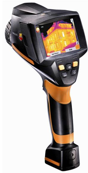
Figura 4: Câmara termográfica
