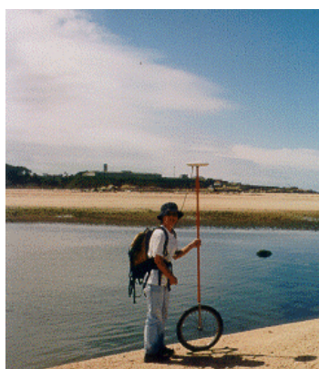
Figura 4.1: Sistema antena GPS transportada pelo operador.
