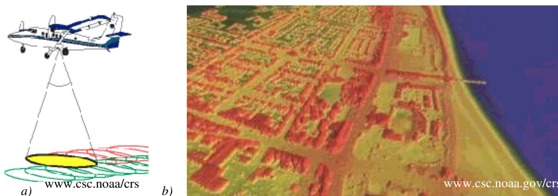
Figura 3.7: a) Mecanismo de varrimento por feixe cônico do sistema ALS em plataforma aerotransportada. b) Pormenor de imagem obtida por ALS.
