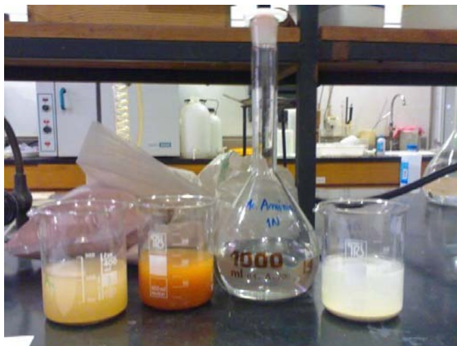
Figura 3.4 - Amostra com 200ml de uma solução de acetato de amónio 1N.
