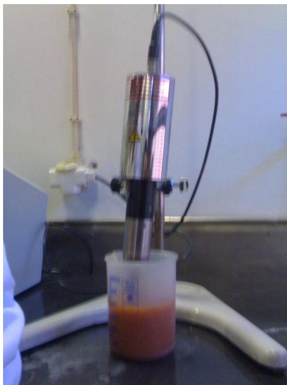
Figura 3.10 - Suspensão de argila/água dispersa com agitador de ultra-sons.
