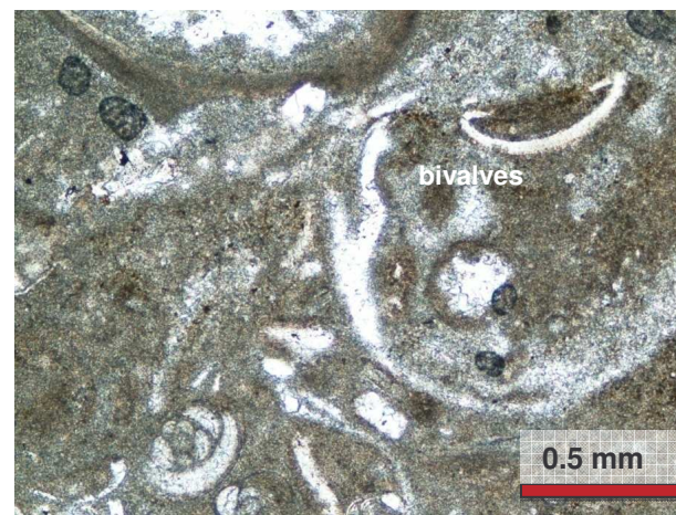
Est. V-4: Bioclastos de bivalves envolvidos por matriz micrítica e argilosa em calcários da F. Caneças - Paragem 4.
