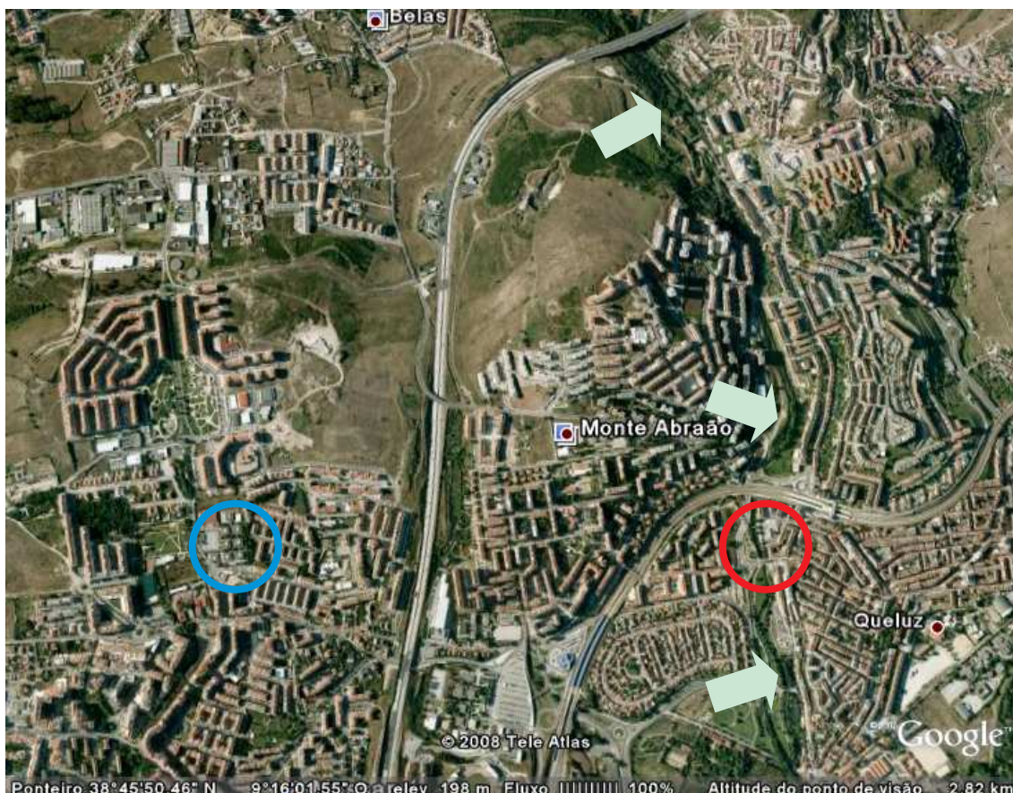
Figura II.12 – Fotografia de satélite da zona de Massamá Norte, Carenque e Queluz. O círculo azul assinala a escola. As setas verdes assinalam o leito do Rio Jamor, vendo-se que muitos prédios foram construídos junto ao leito. O círculo vermelho assinala a zona onde se localizavam os prédios que ruíram nas cheias de 1967 (ver pormenor na figura II.11) ( http://earth.google.com/gallery/ ).
