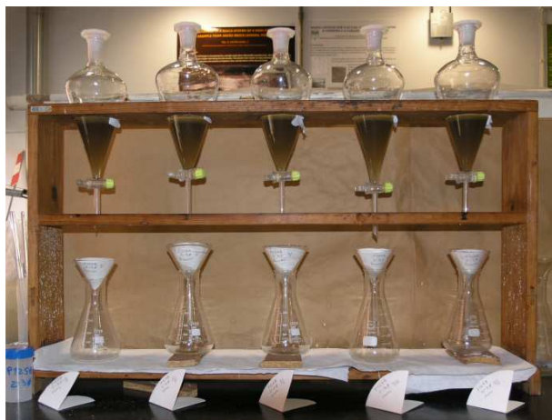
Figura 3.8 – Montagem experimental utilizada na separação de minerais pesados.
