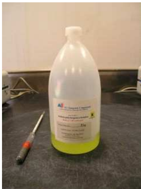
Figura 3.9 – Frasco de Politungstato de sódio (SPT) e densímetro.
