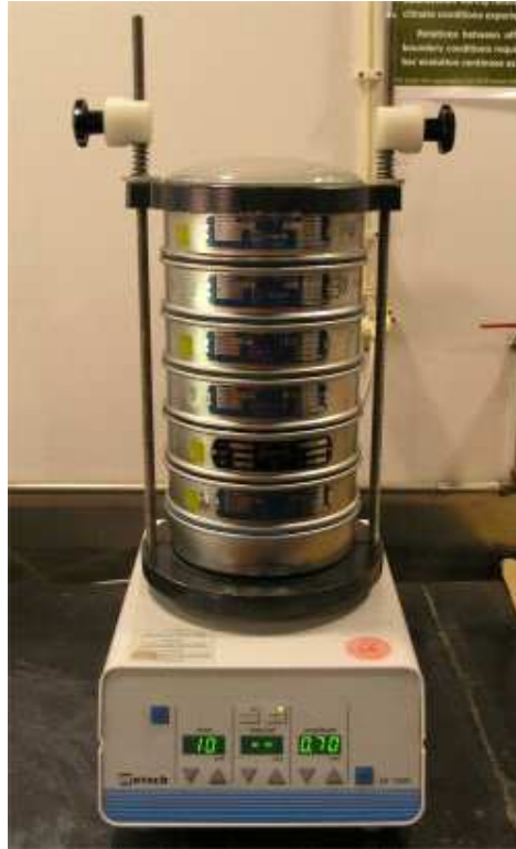
Figura 3.6 – Agitador mecânico e parte da série de peneiros (ASTM) utilizados na separação granulométrica.
