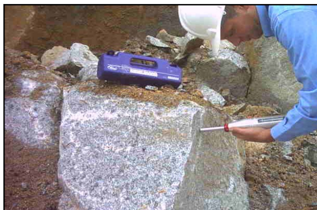
Figura 22. Exemplo de aplicação do martelo de Schmidt (maciço granítico da Mimosa, Penafiel).
