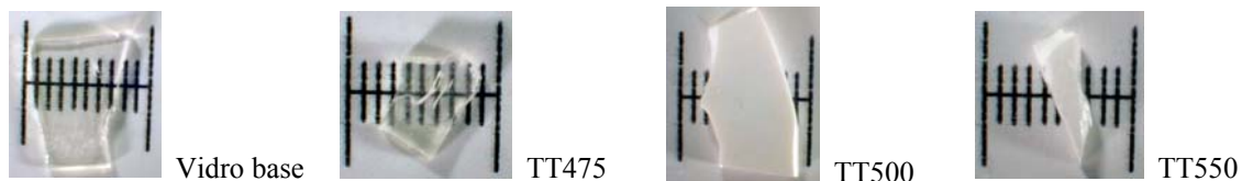
Figura 5.3.2. Fotografias do vidro base, e das amostras tratadas a 475, 500 e 550°C (menor divisão da escala = 1mm) de composição 60BNa.
