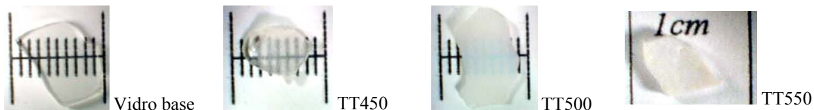
Figura 3.3.2. Fotografias do vidro base 60B, e das amostras tratadas termicamente às T p de 450, 500 e 550°C (menor divisão da escala = 1mm).
