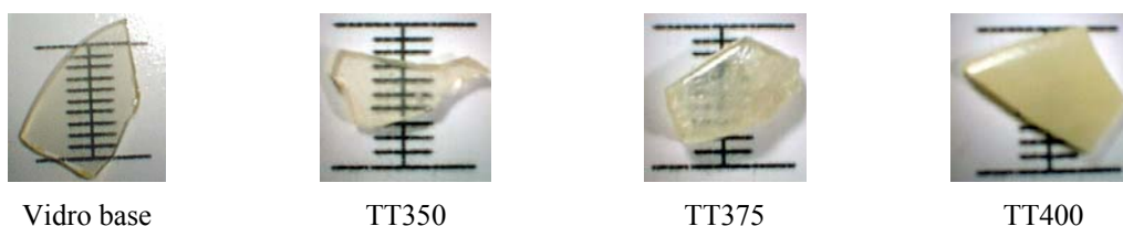
Figura 3.5.2. Fotografias do vidro base 60\text{Te} , e das amostras tratadas termicamente a 350, 375 e 400°C (menor divisão da escala = 1mm).
