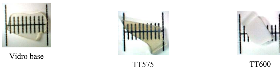
Figura 3.2.29. Fotografias do vidro base 44Si, e das amostras tratadas termicamente a 575 e 600°C (menor divisão da escala = 1mm).
