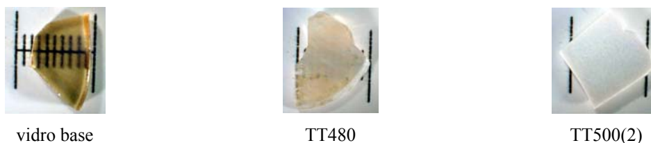
Figura 3.4.3. Fotografias do vidro base 40P, e das amostras tratadas termicamente a 480 (4h) e 500°C (2h) (menor divisão da escala = 1mm).
