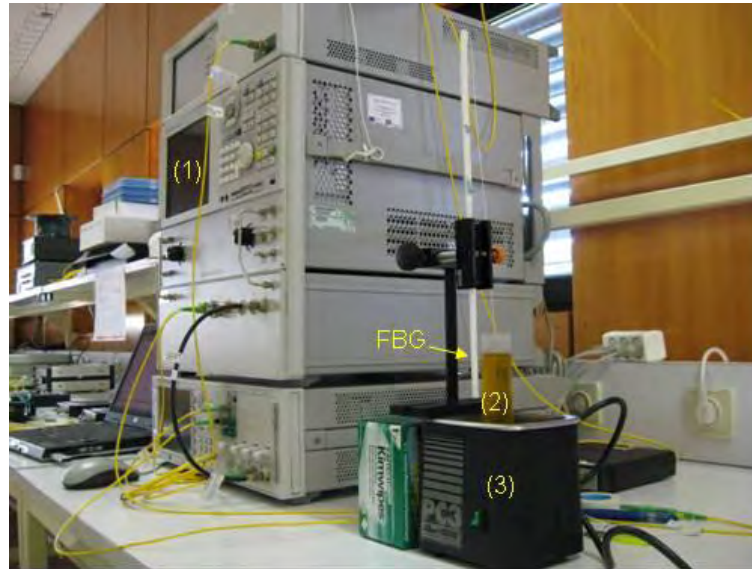
Figura 16 – Montagem usada para as medições com biodiesel adulterado com glicerol. (1) Sistema de interrogação (2) Recipiente com biodiesel; (3) Sistema de mistura.
