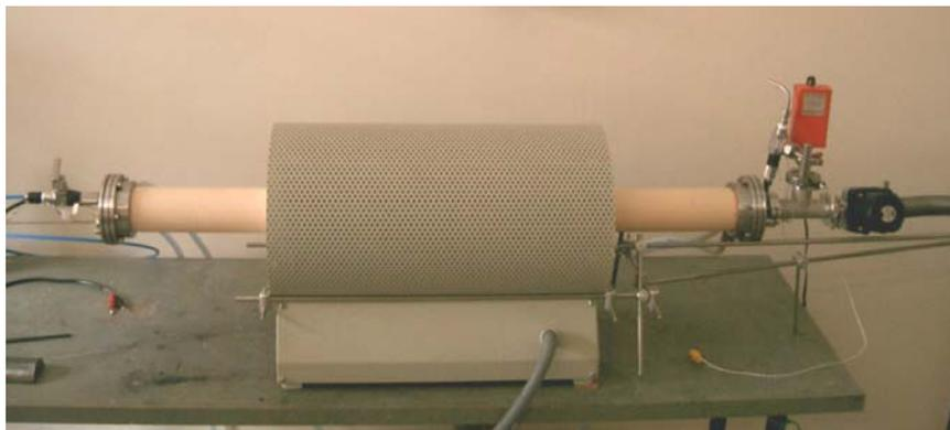
**Figura 20:** Imagem do forno tubular onde se efectuaram as sulfurizações sobre as camadas precursoras [35],[48].
