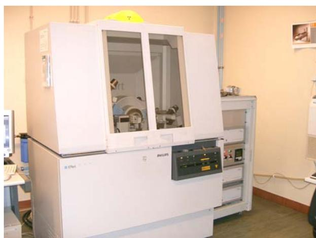
**Figura 34:** Imagem do difractómetro de raio-X utilizado, *Philips X'pert Pro MPD*.
