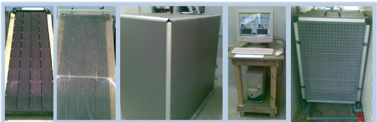
**Figura 23: Fotografias dos componentes usados 1 (da esquerda para a direita: painel *unglazed*, painel *glazed*, reservatório de água, PC de aquisição de dados, refrigerador).**
