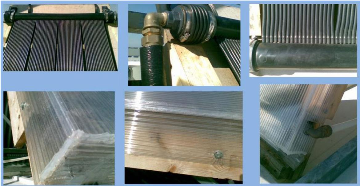
**Figura 25:** Algumas fotos com pormenores dos painéis (em cima painel *unglazed*: as 4 tiras de *epdm*; a ligação do distribuidor com as tubagens; a ligação de cada tira ao distribuidor; em baixo painel *glazed*: o silicone transparente a unir a juntas da cobertura; fixação que permite a dilatação/compressão à cobertura; orifícios nas junções entre os tubos e os distribuidores).
