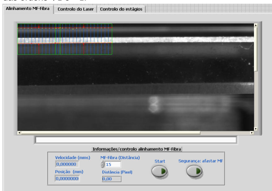
Figura 3.7 – Interface do controlo do alinhamento máscara de fase – fibra óptica.
