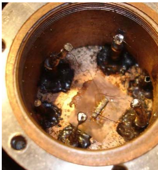
Figura 42: Disposição da amostra MB1-5 no interior do criostato.
