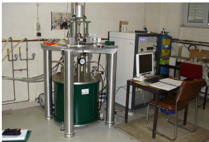
Figura 87: Magnetómetro VSM utilizado nas medidas magnéticas na UA
