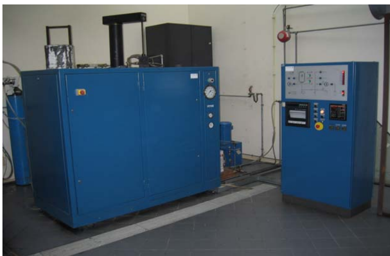
Figura 35: Prensa onde se efectuou o HIPing .
