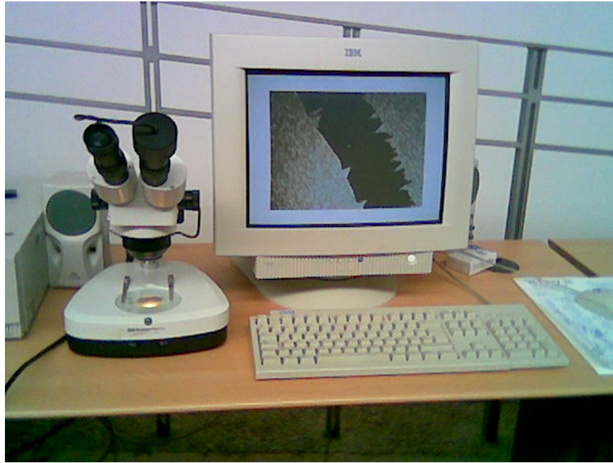
Figura 3.12 – Observación morfológica de las virutas con microscopio óptico
