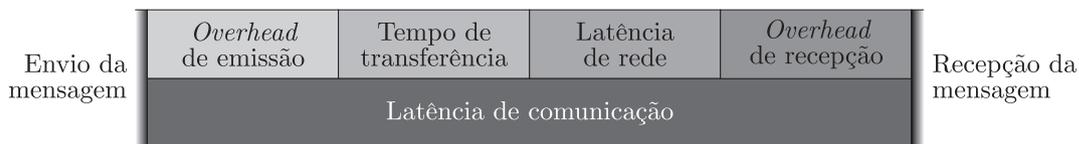
Figura 6.9: Representação esquemática da constituição da latência de comunicação de uma mensagem.
