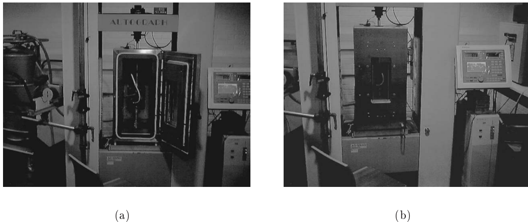
Figura 11.1: Montagem experimental utilizada nos ensaios de tracção uniaxial e de corte puro a diferentes temperaturas. (a) Preparação e (b) ensaio.
