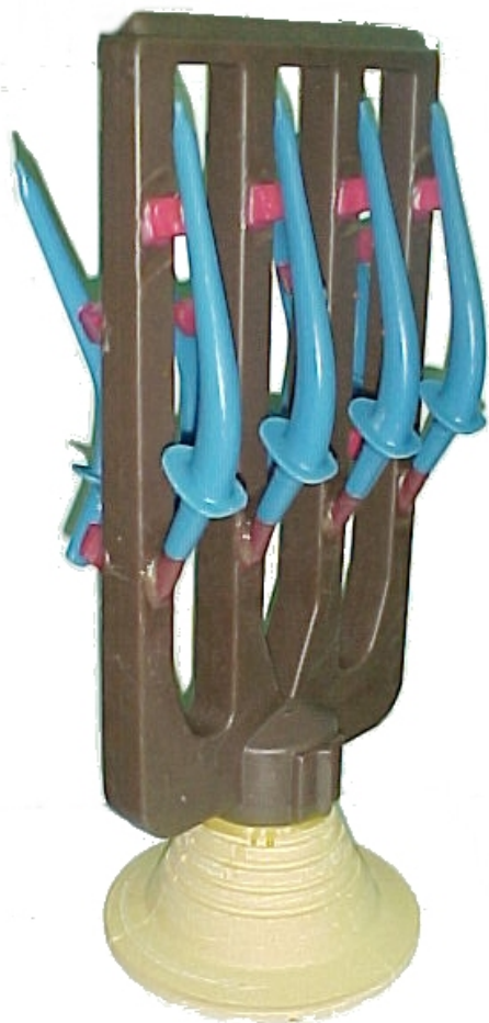
Figura 6.6 – “Cacho” com sistema de gitagem e alimentação (Zollern® Comandita).
