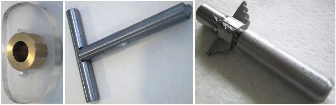
Figura 6.39 – Dispositivos desenvolvidos especificamente para a implantação do novo prato e haste combinada na tíbia.
