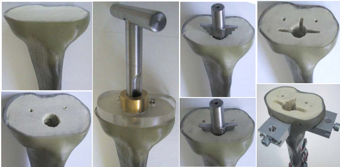
Figura 6.40 – Imagens do procedimento de preparação da tíbia para colocação da haste e prato.
