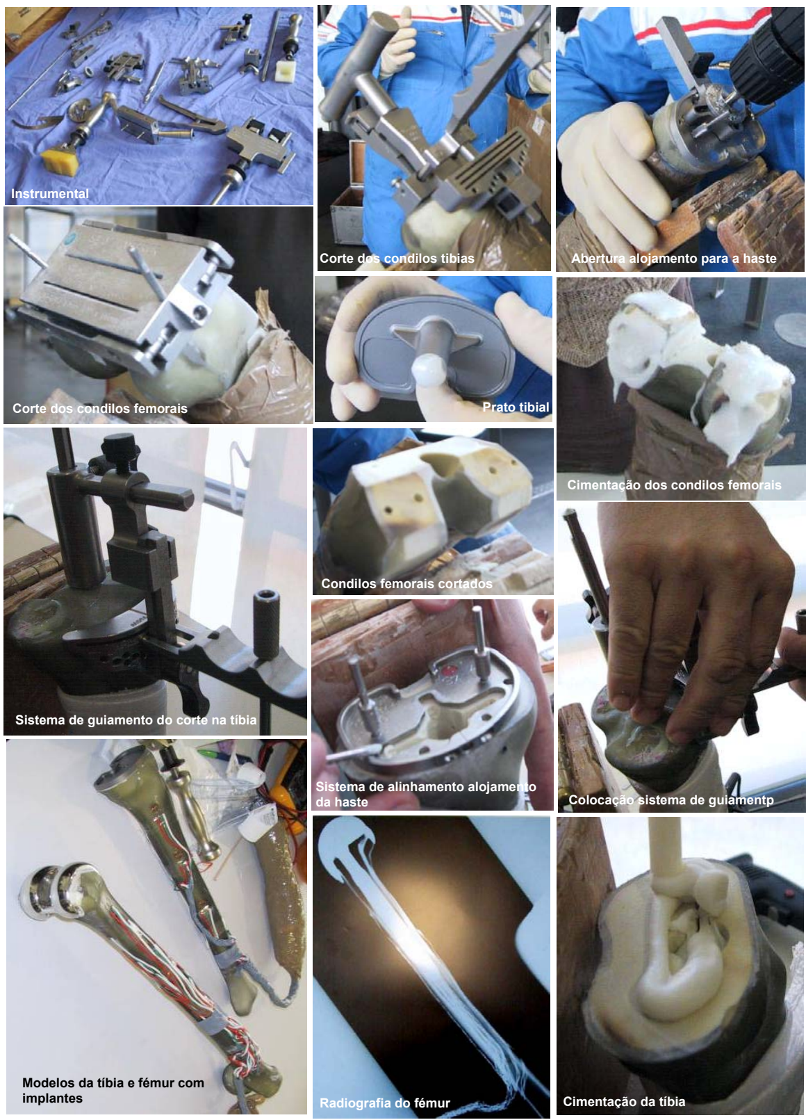
Figura 4.12 – Processo de colocação das próteses nas tíbias e nos fêmures compósitos e radiografia final.
