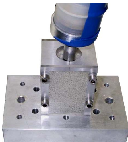
Figura 6.32 – Introdução do cimento ósseo na haste combinada com pistola de injeção.
