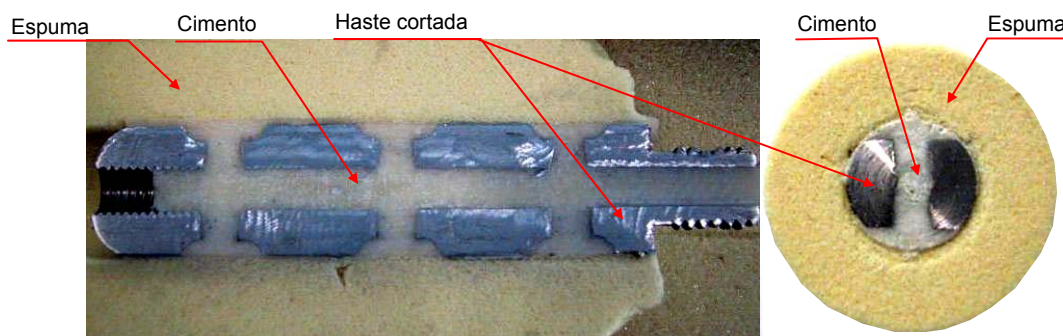
Figura 6.12 – Imagem da haste de fixação combinada cortada após enchimento com cimento.
