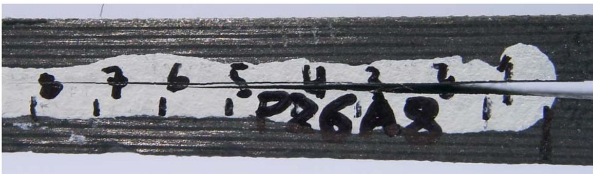
Figura 4.3-13: Fotografia de um provete 0/45 ensaiado na configuração  $G_{II}/G \approx 25\%$ .
