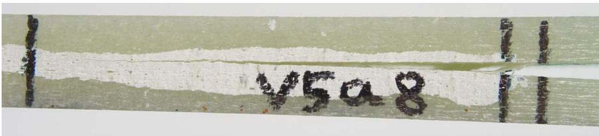
Figura 4.2-6: Fotografia de um provete vidro/epóxico 45/-45.
