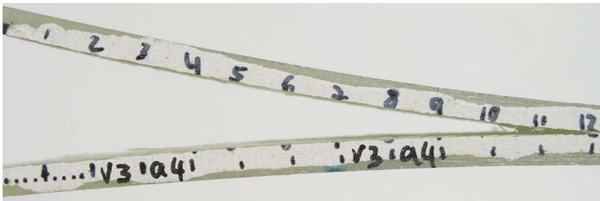
Figura 4.1-12: Fotografia de um provete vidro/epóxico 0/0.
