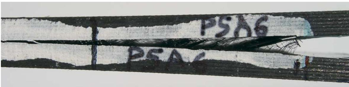
Figura 4.2-19: Fotografia de um provete carbono/epóxico 30/-30.
