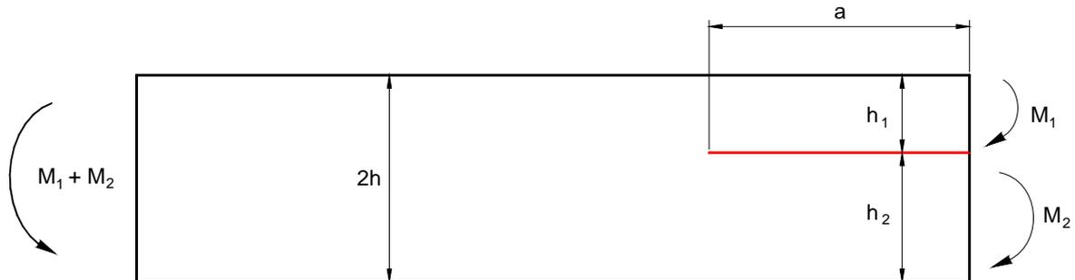
Figura 1.4-10: Laminado com uma delaminação sujeito a momentos flectores.
