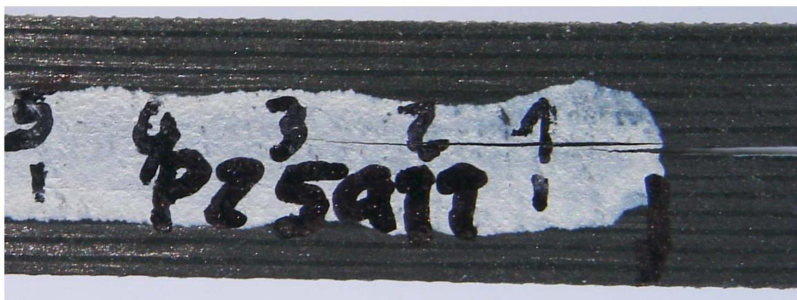
Figura 4.3-14: Fotografia de um provete 0/90 ensaiado na configuração  $G_{II}/G \approx 25\%$ .
