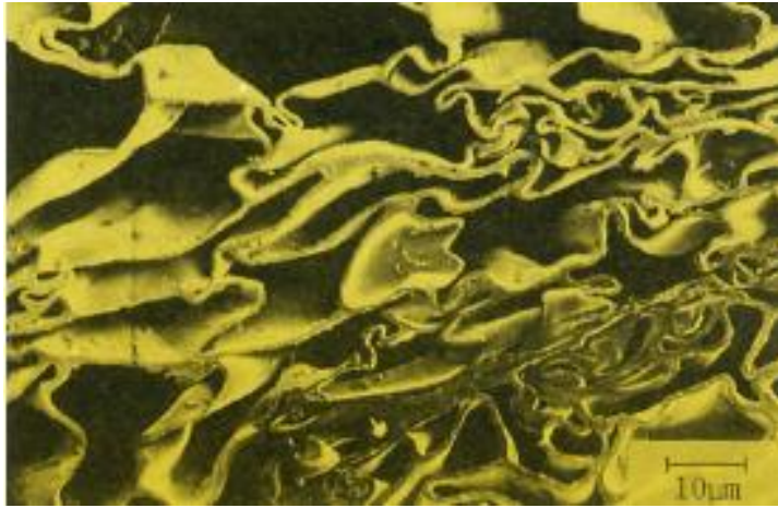
Figura 10: Encurvadura e Esmagamento das paredes das células de cortiça na direcção radial [Fortes, 1989].
