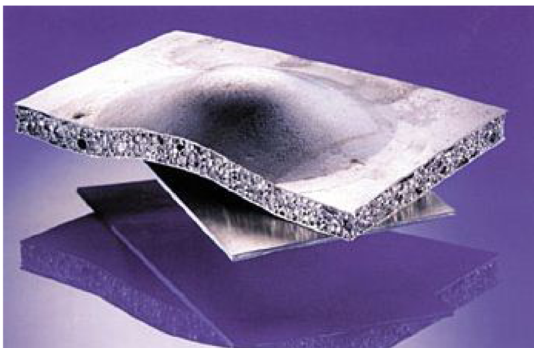
Figura 1.2: Exemplo de estrutura sandwich com núcleo em alumínio [Banhart 00].
