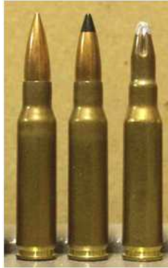
Figura 2.1: Da esquerda para a direita, munições utilizadas em Portugal: 7.62×51 mm NATO Ball m/963, 7.62×51 mm NATO Armor-Piercing m/963 e 7.62×51 mm NATO Blank
