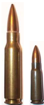
Figura 2.6: Munições de calibre 7.62 mm. (a) Cartucho 7.62×51 mm NATO e (b) Cartucho soviético 7.62×39 mm
