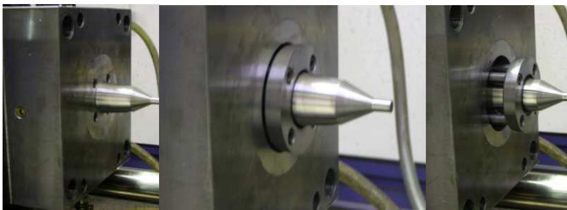
Figura 5.23 – Fases da extracção do molde (Versão 1)
