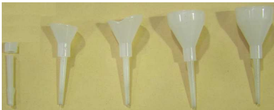
Figura 5.4 – Sequência de enchimento das peças da versão 1
