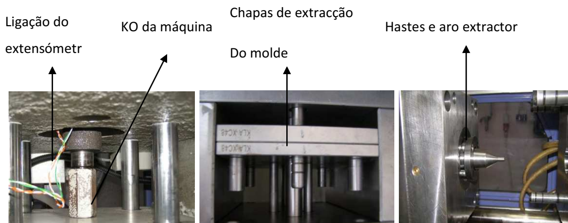
Figura 5.14 – Accionamento do sistema de extracção
