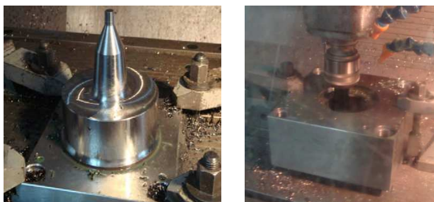
Figura 4.12 – Bucha e cavidade no centro de maquinação CNC (IPL-ESTG)
