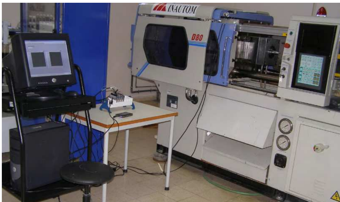
Figura 5.18 – Sistema de aquisição de dados, molde e equipamento de injecção
