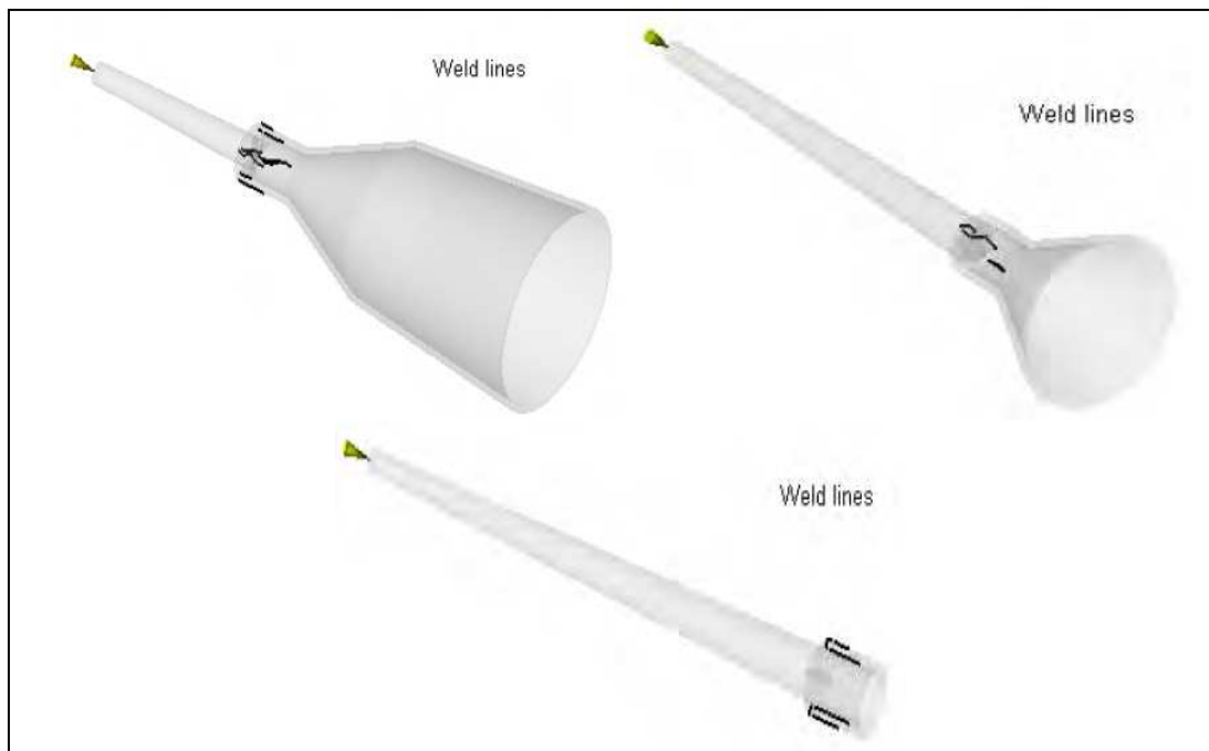
Figura 3.18 - Previsão das linhas de soldadura das peças
