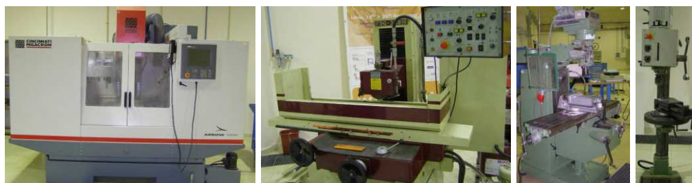
Figura 4.16 – Centro de maquinação CNC, rectificadora, fresadora e engenho de furar (Equipamentos do IPL-ESTG)
