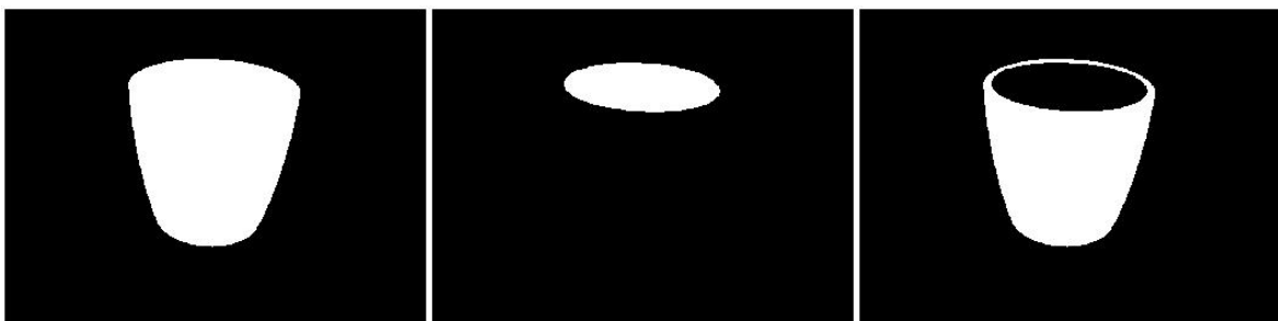
Figura 3.22 – Exemplo de aplicação da operação da subtração binária
