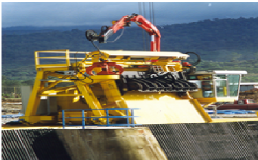
Figura 8 – Descolmatador móvel de accionamento por cabo do fabricante Alstom [7].
