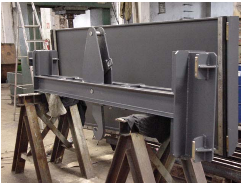
Figura 13 – Balancim automático para manobra das comportas ensecadeiras instaladas na Estação Elevatória de Aravil, no Aproveitamento Hidroagrícola de Idanha-a-Nova.
