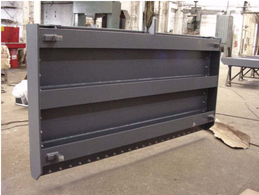
Figura 14 – Elemento de comporta ensecadeira instalada na Estação Elevatória de Aravil, no Aproveitamento Hidroagrícola de Idanha-a-Nova.
