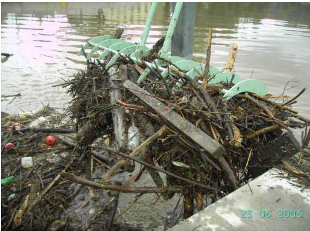
Figura 3 – Garra de descolmatador com uma carga de detritos na fase final da operação de limpeza [2].
