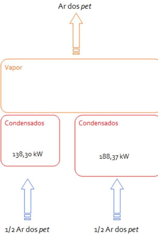
Figura 7.3: Representação do sistema de aproveitamento de condensados actual e respectiva capacidade dos permutadores no aquecimento do ar dos alimentos compostos para *pet*.
