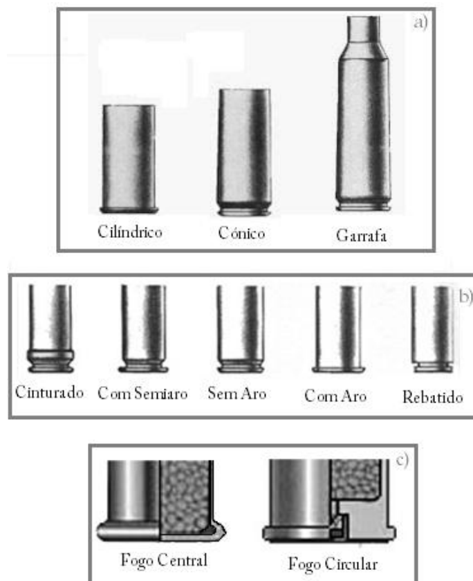
Figura 2.7- Representação de invólucros classificados quanto ao tipo de (a) corpo, (b) base e (c) tipo de iniciação.
