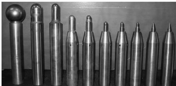
Figura 19 – Ferramentas com extremidade esférica sólida de conformação [VIH07].
