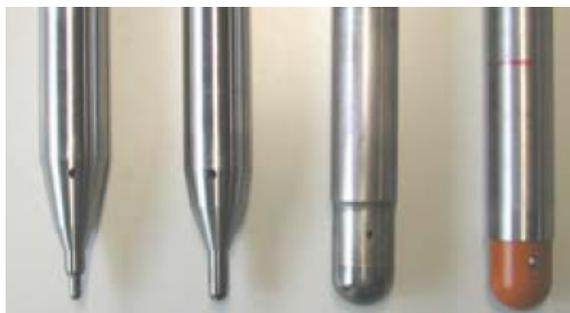
Figura 21 – Ferramentas de conformação de ponta esférica sólida com 6,10,30mm de diâmetro e com ponta de plástico (direita) [JES05].
