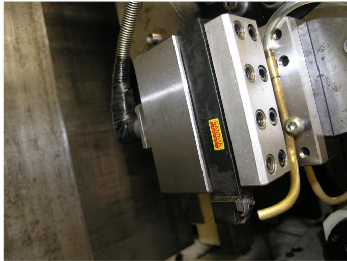
**Figura 3.7 – Porta ferramenta utilizado nos ensaios experimentais em conjunto com o sistema de lubrificação e dinamómetro.**
