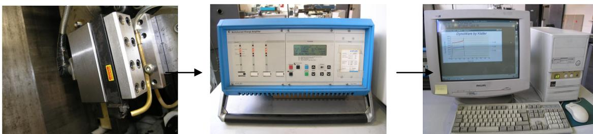
**Figura 3.11 – Sistema de aquisição de dados das Forças de corte a) dinamómetro piezoeléctrico b) amplificador de sinal c) computador**
