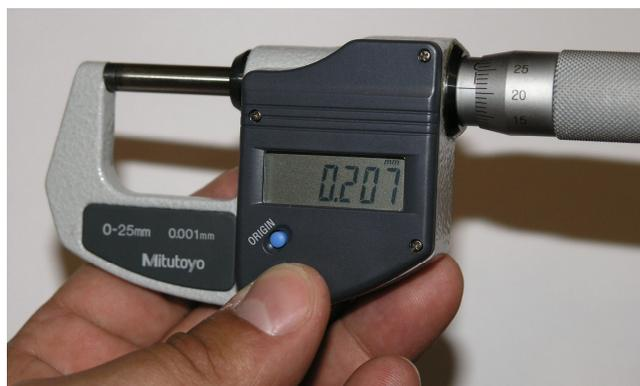
Figura 3.14 – Realização da medida da apara com o micrómetro digital Mitutoyo®
