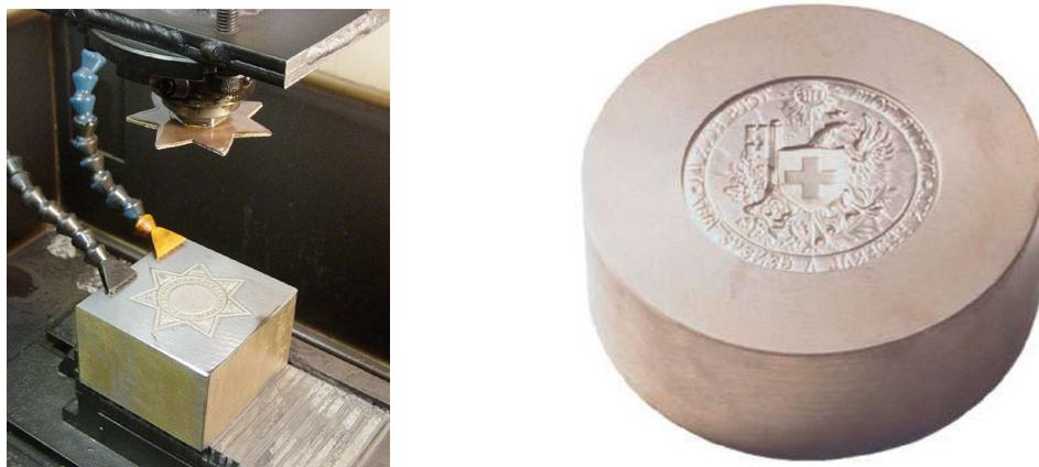
**Figura 2.3 – Exemplos de peças de grande precisão realizadas numa máquina de EDM por penetração (Stoeterau et al, 2007)**
