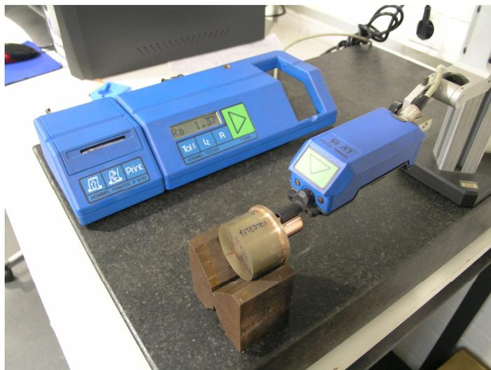
**Figura 3.17 – Medição da rugosidade da superfície do provete de ensaio (liga de WCu25) com o rugosímetro**
