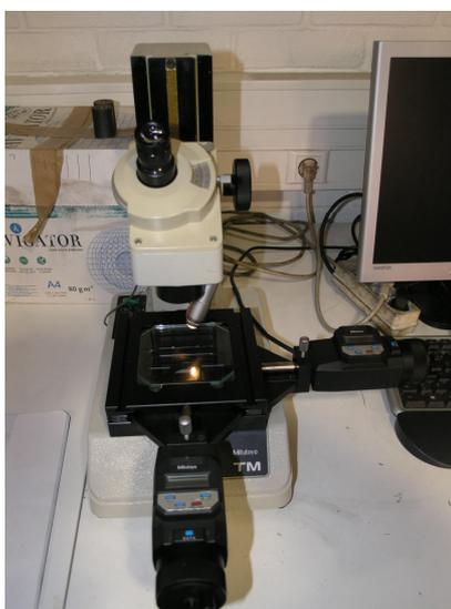
**Figura 3.16 – Observação do desgaste da ferramenta no microscópio óptico de oficina Mitutoyo TM-500**
