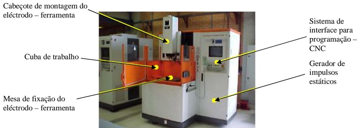
**Figura 2.2 – Exemplo de uma máquina de EDM por penetração (Nelson, 2006)**
