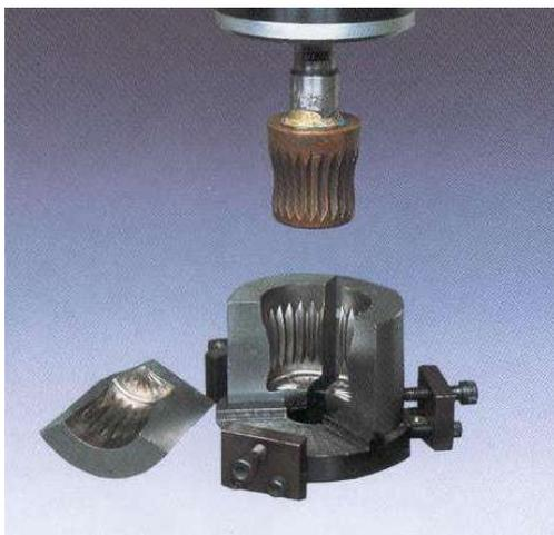
Figura 2.7 – Exemplo de uma peça electroerodida (Stoeterau et al, 2007)
