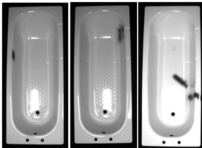
Fig. 111 - Exemplos de falta de esmalte
