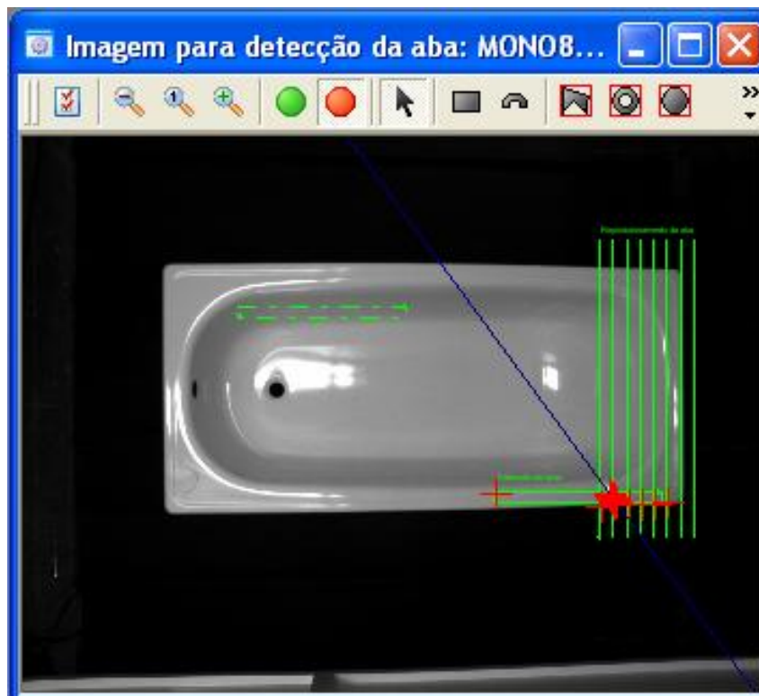
Fig. 85 - Processo de detecção da aba
