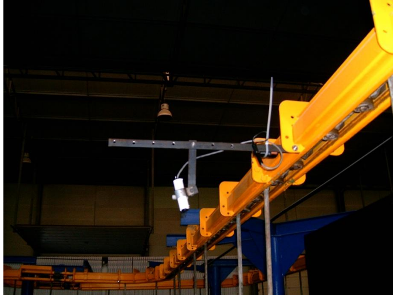
Fig. 31 - Configuração correcta do suporte do laser
