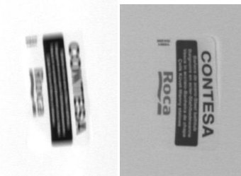
Fig. 35 - Imagem do autocolante da marca Roca adquirida com um tempo de exposição de 1/30 s e com um tempo de exposição de 1/60 s respectivamente
