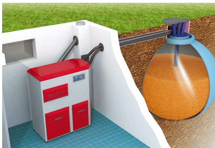
Figura 27. Depósito subterrâneo exterior [12].
