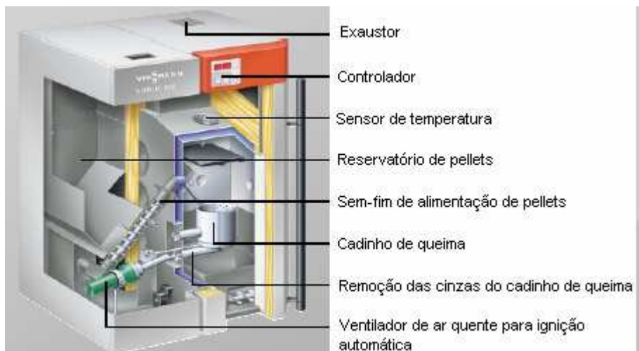
Figura 14. Caldeira a pellets Vitolig 300 [11].
