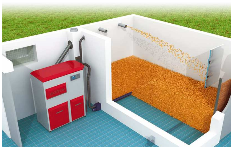
Figura 25. Depósito de extracção por vácuo com pontos de sucção [12].
