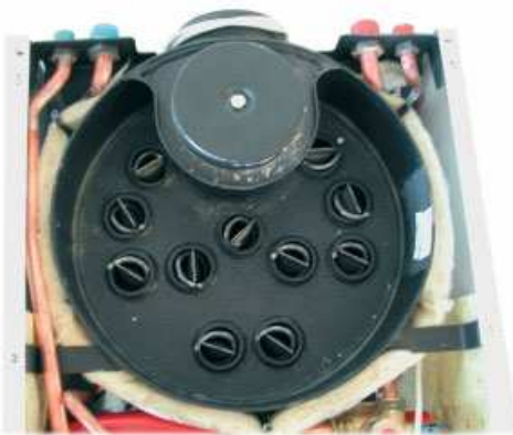
Figura 7. Permutador de carcaça e tubos em aço refractário [5].
