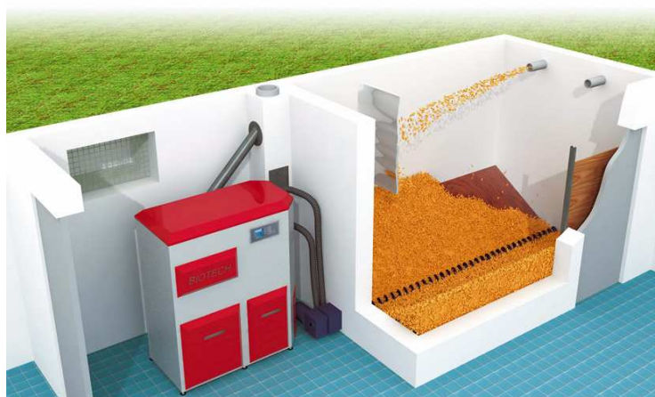
Figura 24. Depósito de extracção por vácuo com transportador de parafuso [12].
