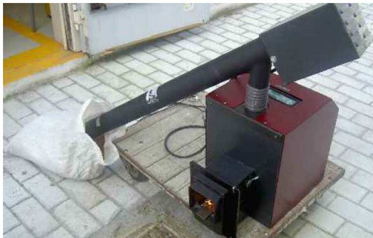
Figura 28. Queimador de pellets horizontal [28].
