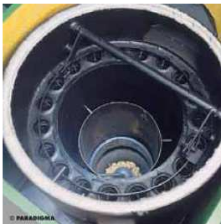
Figura 13. Permutador de calor com sistema de limpeza automático [10].
