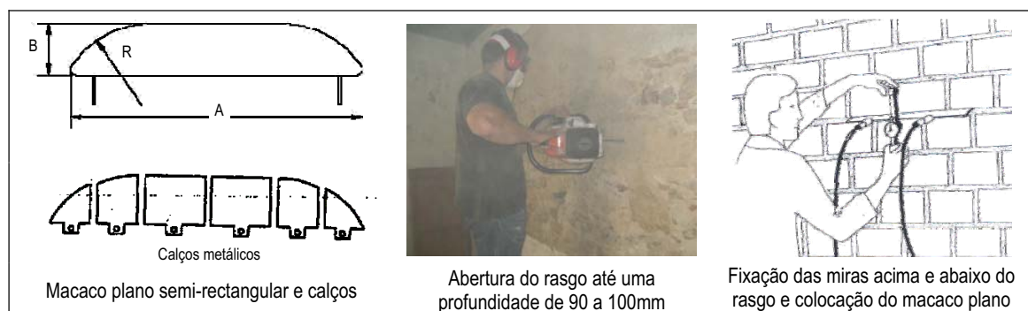
Figura 133: Ensaio simples: macaco plano semi-rectangular, abertura do rasgo e medição entre miras
