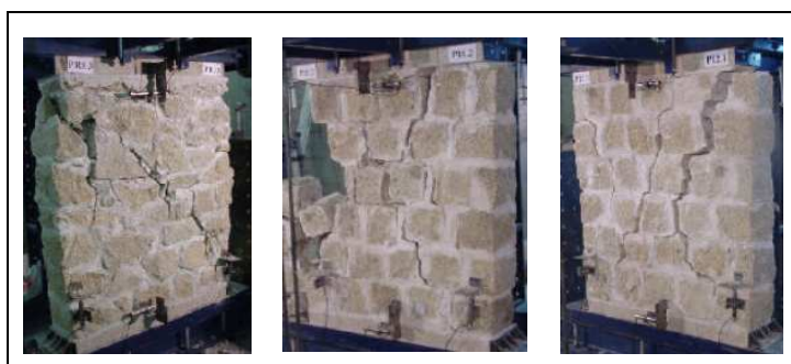
Figura C31: Modos de rotura de paredes de alvenaria no seu plano [Vasconcelos, 2005]
