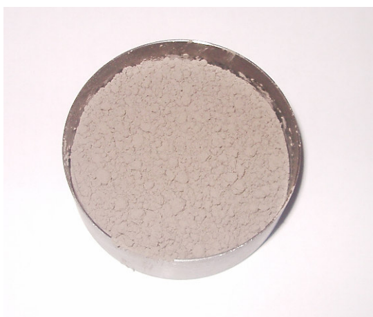
Fig. 6.12 Resíduo de Argila Expandida (RAE)
