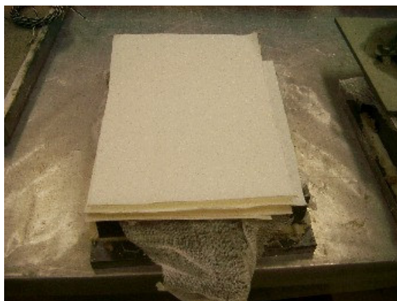
Fig. 6.59 Preparação de provetes segundo EN 1015-11. Colocação de papel de filtro
