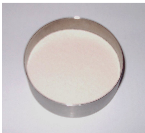
Fig. 6.6 Pozolana de Cabo Verde (PCV)
