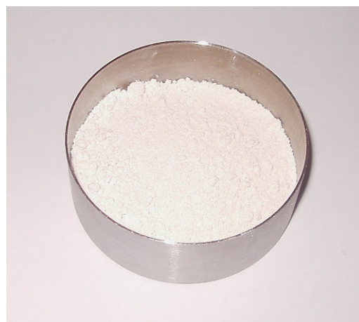
Fig. 6.7 Pozolana de S. Miguel, Açores (PA)
