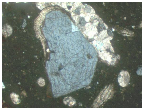
Fig. 5. 68 Precipitação de calcite microcristalina à volta de grão de quartzo (CON 9)
