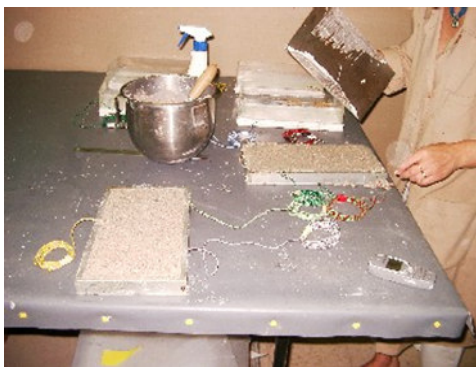
Fig. 6.56 Execução de provetes para ensaio de impermeabilização
