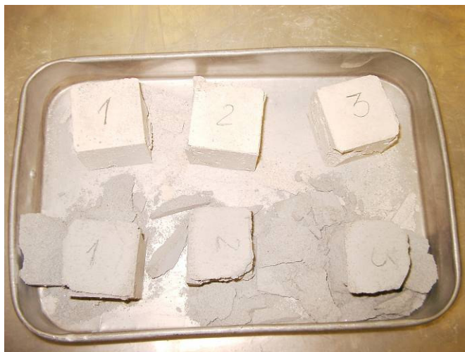
Fig. 6.48 Provetes preparados segundo a norma ASTM 593-95 após ensaio à compressão
