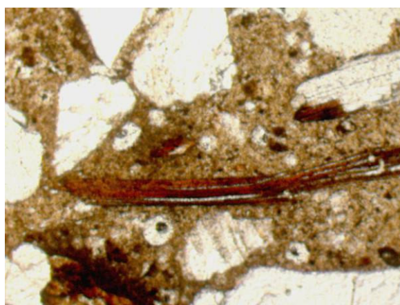
Fig. 5. 62 Quartzo e minerais micáceos em matriz calcítica (CSC 2)
