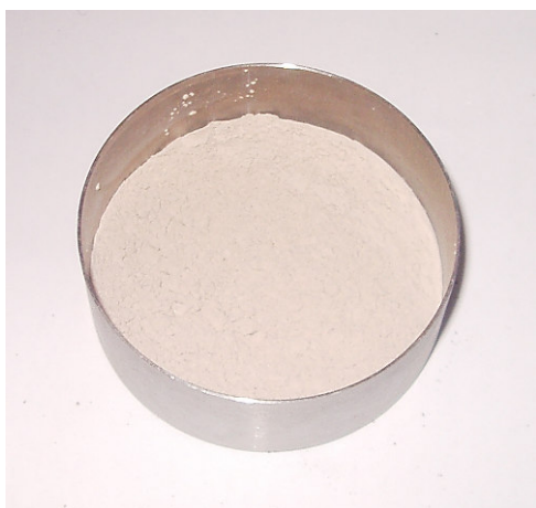
Fig. 6.6 Pozolana de Cabo Verde (PCV)
