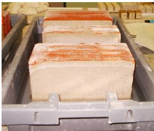
Fig. 6.72 Ensaio de resistência aos sais em curso
