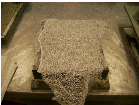
Fig. 6.58 Preparação de provetes segundo EN 1015-11. Colocação de gaze
