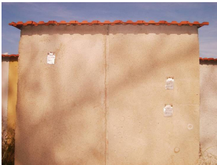
Fig. 6.91 Aplicação de argamassas de reboco com Pozolana de Cabo Verde e Pozolana dos Açores
