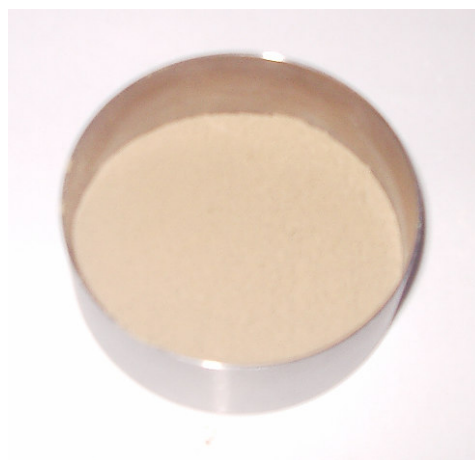
Fig. 6.7 Pozolana de S. Miguel, Açores (PA)
