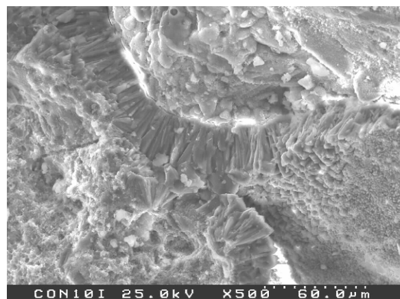
Fig. 5. 58 Preenchimento fissuras com calcite (CON 9)
