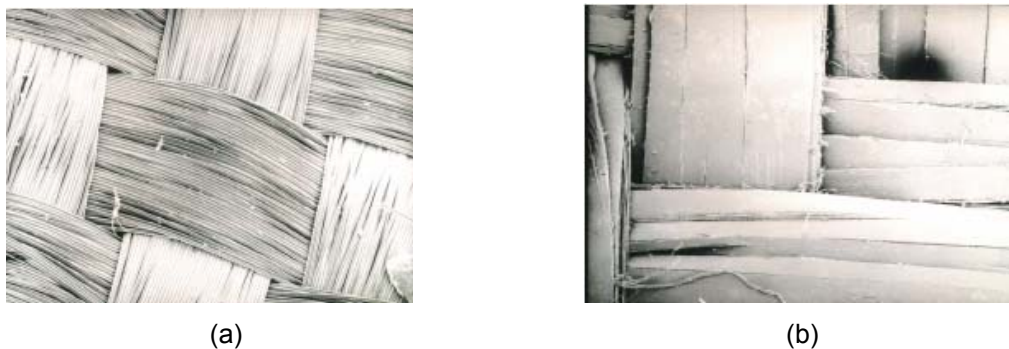
Figura 2.6. Estrutura típica de geotêxteis tecidos: (a) em multifilamentos de PET; (b) com fitas de PP (Pinho Lopes, 2006)
