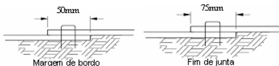
Figura 2.19. Pormenores de execução da solução proposta na Figura 2.18 (Iowa Highway Research Board, 2006)
