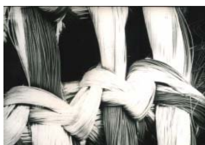
Figura 2.7. Estrutura de um geotêxtil tricotado (Pinho Lopes, 2006)
