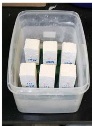
Figura 42 - Ensaio de capilaridade
