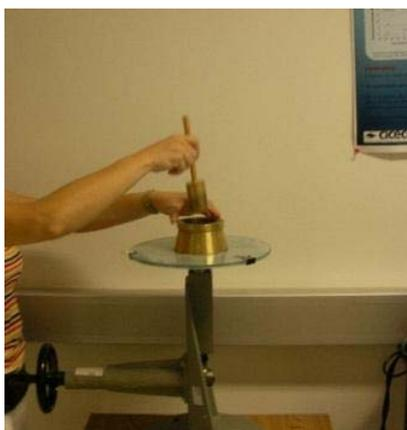
**Figura 35 - Ensaio de espalhamento**
