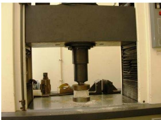
Figura 41 - Ensaio de resistência por compressão
