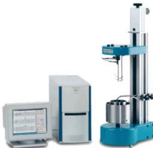
**Figura 39 - Reometro utilizado para argamassas (Viskomat)**
