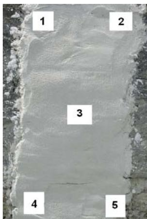
Figura 60 – Medições efectuadas pelo esclerômetro
