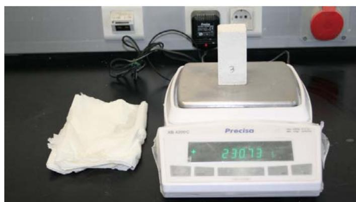
Figura 43 - Pesagem continua ao longo do tempo dos provetes
