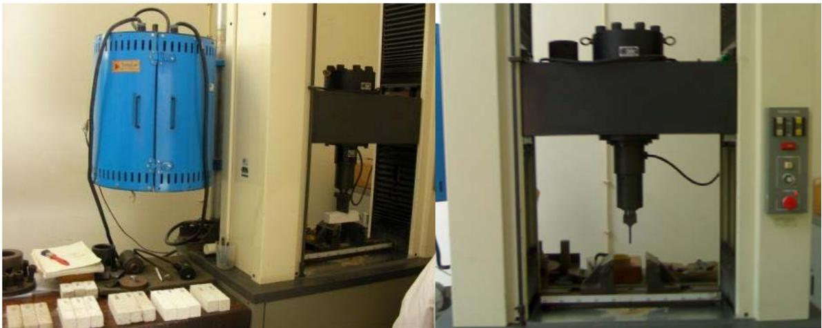
Figura 40 - Ensaio de resistência à tracção por flexão
