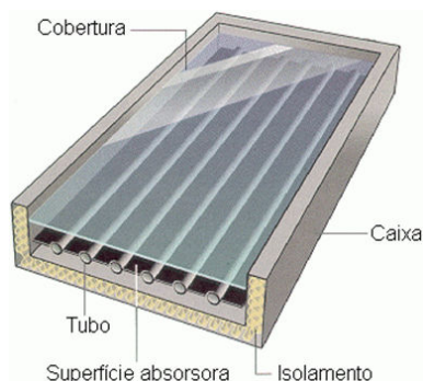
Figura 12 – Esquema de um colector plano
