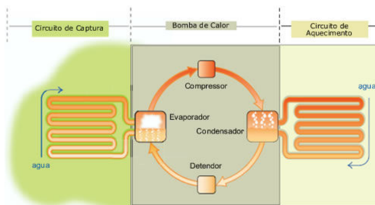
Figura 19 – Esquema de funcionamento de uma bomba de calor [32]
