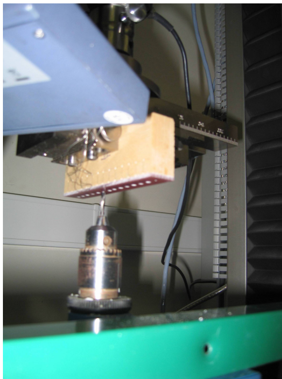
Figura 12: Pormenor da montagem experimental, com o berbequim a furar o polímero, com medição de temperatura pelos termopares colocados a duas cotas diferentes
