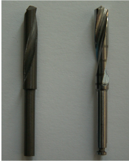
Figura 2: Broca de nitreto de silício (esquerda) e broca comercial de aço (direita) usada como modelo
