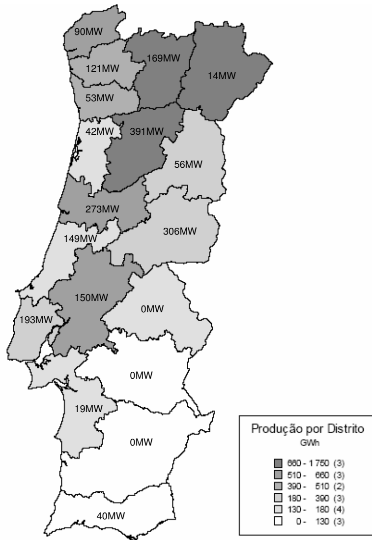
Figura 27 – Mapa da distribuição da potência eólica instalada e respectiva produção de electricidade por distritos, em Setembro/07. (DGEG, 2007)
