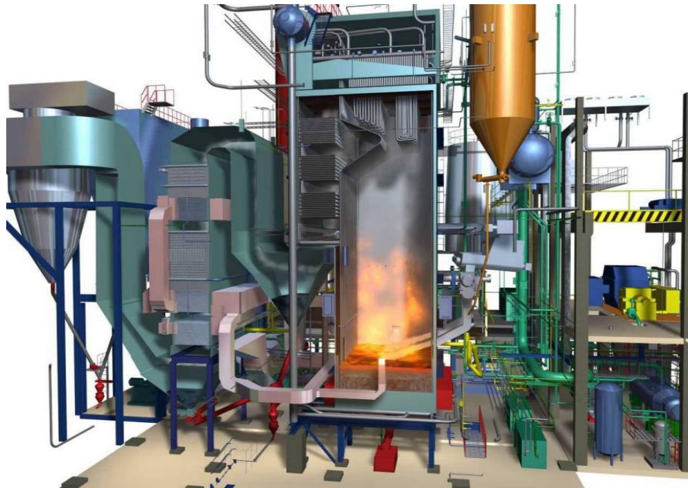
Figura 3-3. Esquema ilustrado de uma caldeira de leito fluidizado (ECOCEL, 2000).
